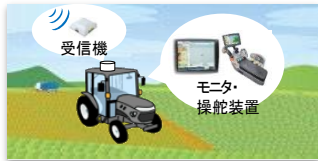
高い精度での作業を可能とし、作業重複を削減することで省エネに資する「自動操舵装置」の普及促進
